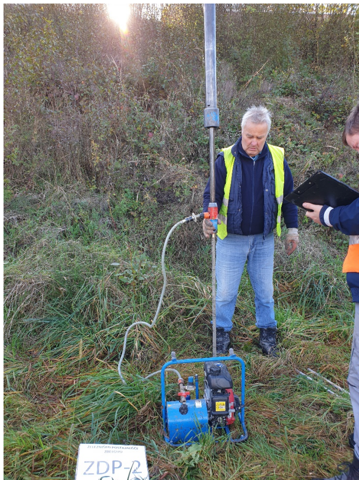
Slika 4: Izvedba dinamičnih penetracij.
